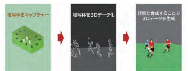
出演者などの現実世界を取り込み、3Dモデルとして蓄積するため、空間内の自由な位置や角度からの映像やXRなど、多彩なデータの生成が可能です。カメラワークを自在に編集できるので、上空を自由に飛んだり、地面の下から見上げるようなアングルを撮影できたりと現実空間では見られない映像が制作できます。
